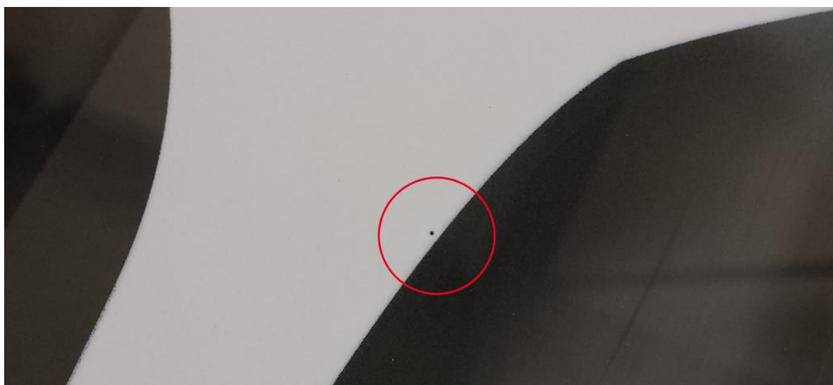
Пример за по-видим точков дефект от непокриване на боята, погледнат от около 30-40 см.
